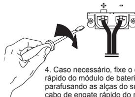
4. Caso necessário, fixe o conector de engate rápido do módulo de baterias ao nobreak, parafusando as alças do suporte de fixação do cabo de engate rápido do módulo de baterias.
